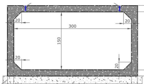
L'Usine de Coprem, propose a Bonna Sabla de réaliser l'ouvrage en 2 lignes juxtaposées de cadres 300\*150 en épaisseur 16, parfaitement justifiés aux Eurocodes. L'ensemble est fabriqué et rendu disponible en 2 semaines.
